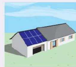
Les capteurs couvrent la totalité du pan de toiture du garage
