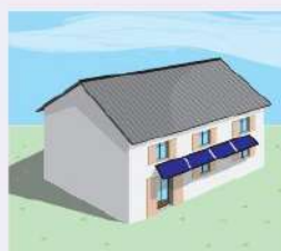
Les capteurs forment un auvent qui crée une ombre portée sur les fenêtres du rez-de-chaussée en été
